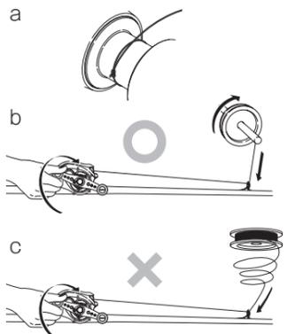
尚、PE ラインを巻かれる時は、事前に PE ラインを十分に湿らせてください。巻き上げ時に発生する熱（抵抗熱）によって PE ラインが劣化するのを防ぐためです。
